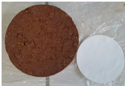
Figure II-27 : Mesure de la succion par papier-filtre
