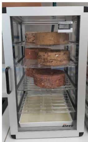
Figure II-28 : Dessiccateur avec solution saline saturée
