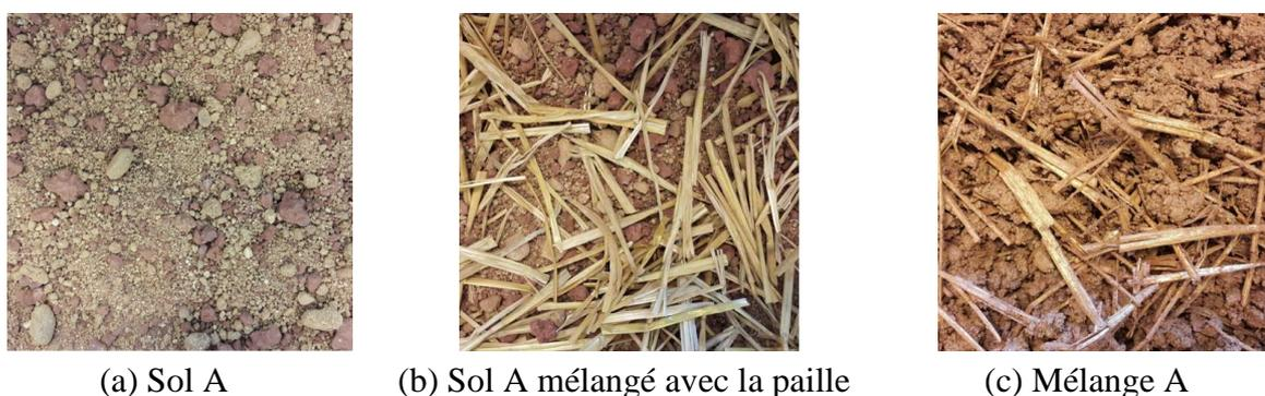
Figure II-14 : Etapes de préparation d'un mélange terre-fibre.
