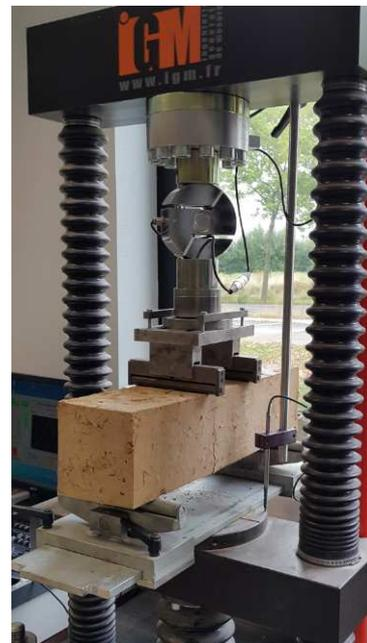
(b) L'essai flexion quatre points
