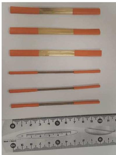
(a) Fibres utilisés pour l'essai de traction
