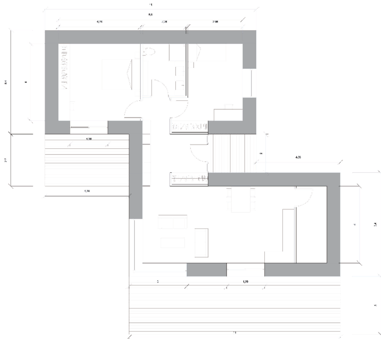
Petit pavillon : Plan rez-de-chaussée 1/75 eme avec côtes
