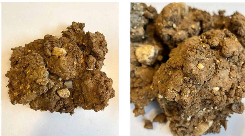
*Figure 1 : Exemple d'une terre convenable pour une couche de CobBauge structurale.
