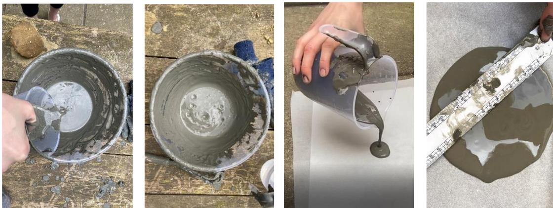
Figure 16 : Essai de flaque de barbotine d'argile pour le mélange de bauge thermique. Photos : Olivia Elsey (2022).
