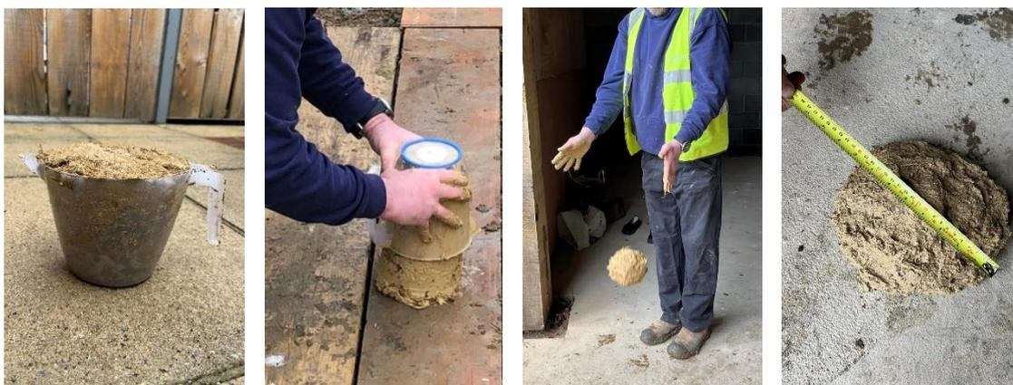
Figure 15 : Méthodologie d'essai d'impact de masse pour les mélanges de bauge structurale. Photos : Katey Oven (2022).
