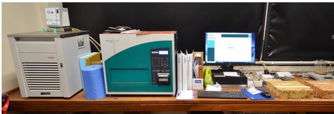
Figure 14 : Exemple d'appareil de mesure du flux thermique et échantillon test de bauge thermique.
