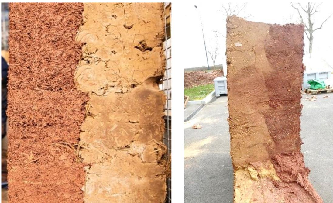
Figure 23 : Jointure en dents de scie angulaires entre couches structurelles et thermiques. Photos : University of Plymouth, projet CobBauge
