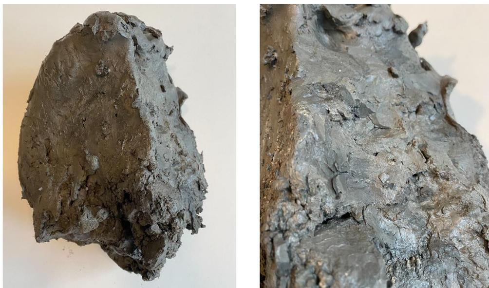
Figure 2 : Exemple d'une terre convenable pour une couche de CobBauge thermique.
