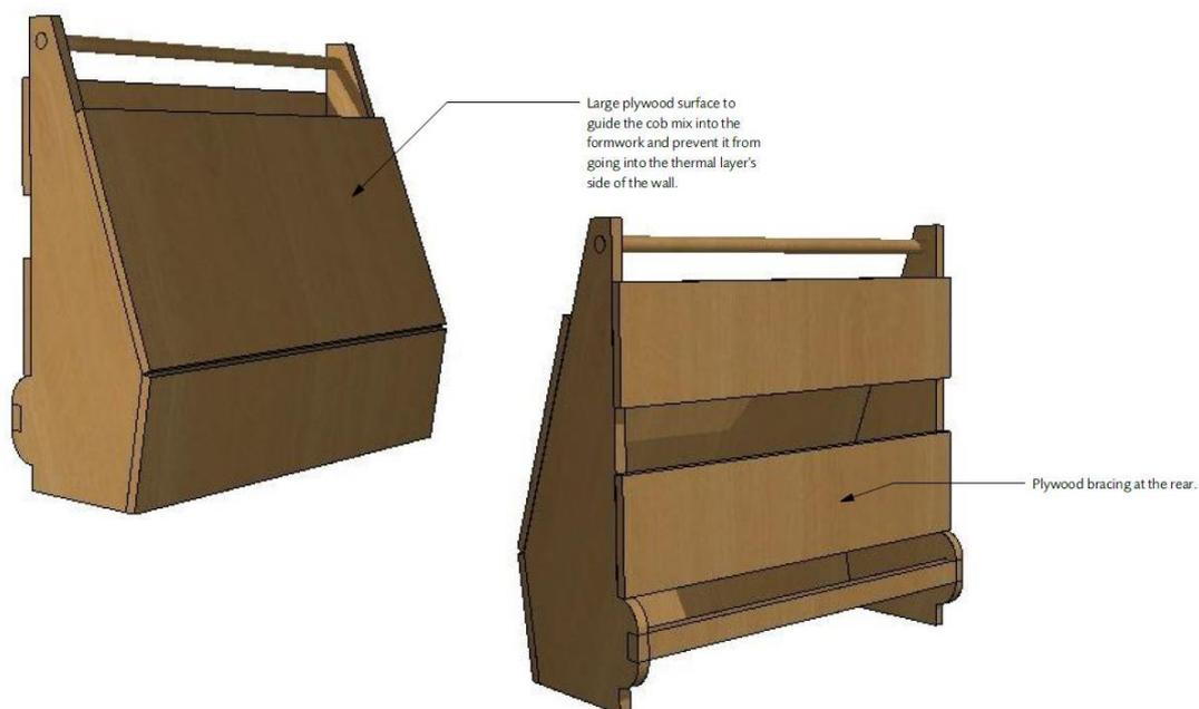
Figure 22 : Aperçus en 3D d'un outil de pose CobBauge. Source : Hudson Architects (2022).
