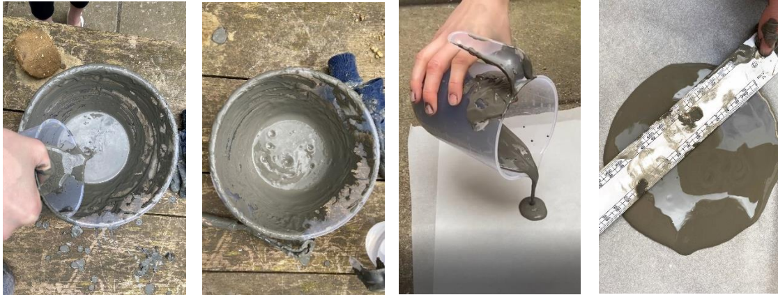
Figure 16 : Essai de flaque de barbotine d'argile pour le mélange de bauge thermique. Photos : Olivia Elsey (2022).
