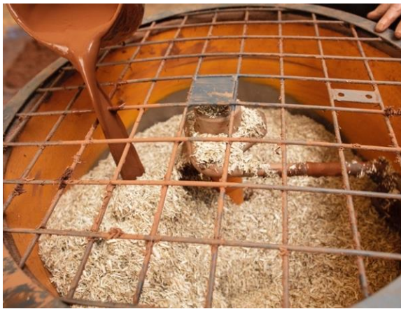
Figure 11 : Mélange de la barbotine d'argile et des fibres de copeaux de chanvre hors site utilisant un malaxeur Baron. Photo : Plymouth University.
