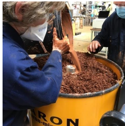
Figure 11 : Mélange de la barbotine d'argile et des fibres de copeaux de chanvre hors site utilisant un malaxeur Baron. Photo : Plymouth University.
