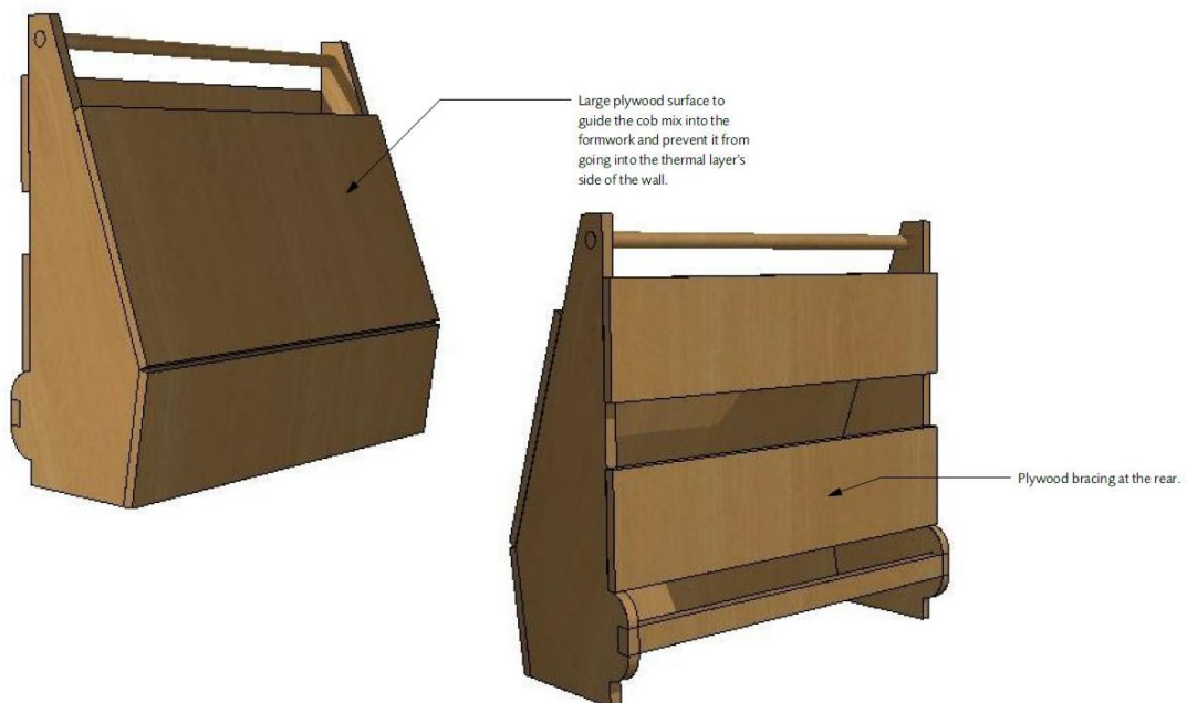
Figure 22 : Aperçus en 3D d'un outil de pose CobBauge. Source : Hudson Architects (2022).
