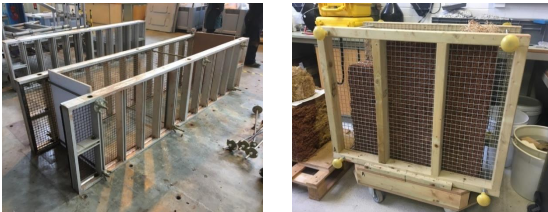
Figure 17 : Exemples de coffrage métallique (gauche) et en bois (droite). Photos : ESITC Caen (2022) (gauche), Plymouth University, projet CobBauge (2021).
