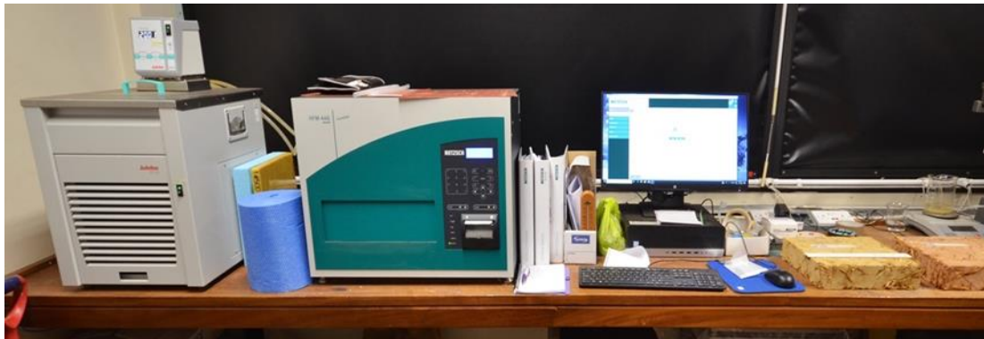
Figure 14 : Exemple d'appareil de mesure du flux thermique et échantillon test de bauge thermique. Photo : Plymouth University, projet CobBauge.
