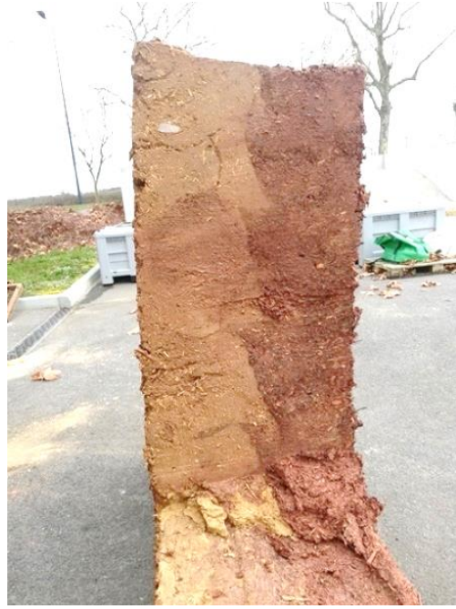
Figure 23 : Jointure en dents de scie angulaires entre couches structurales et thermiques. Photos : University of Plymouth, projet CobBauge
