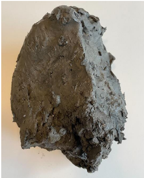
Figure 2 : Exemple d'une terre convenable pour une couche de CobBauge thermique. Photos : Katey Oven.
