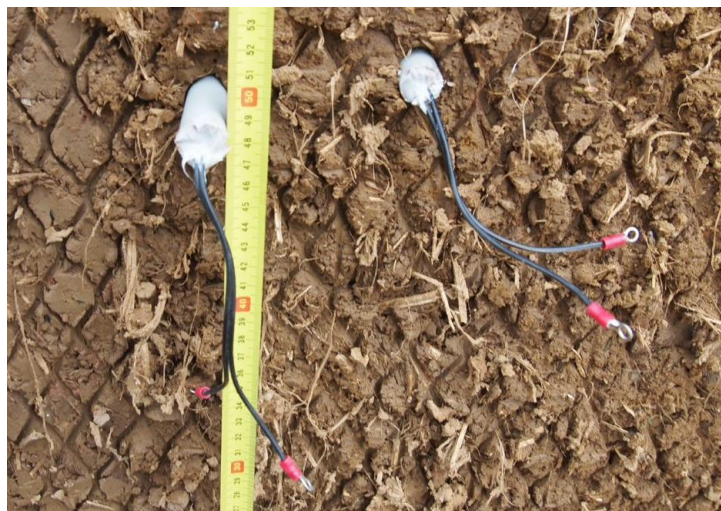
Figure 32. Capteurs Ramin installés dans une première levée de CobBauge. Source : François Streiff.
