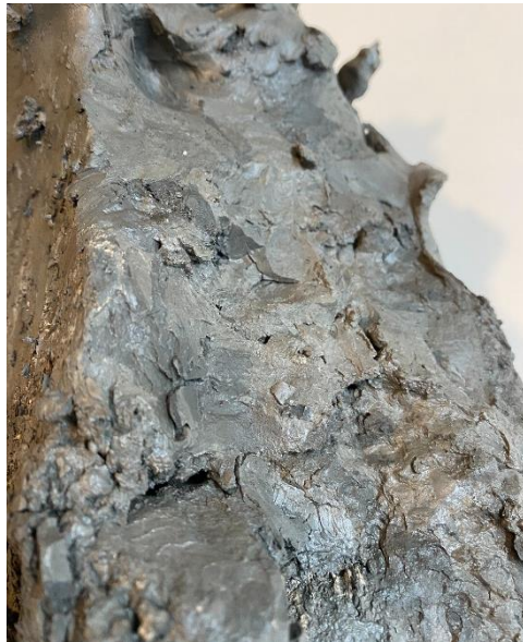
Figure 2 : Exemple d'une terre convenable pour une couche de CobBauge thermique. Photos : Katey Oven.
