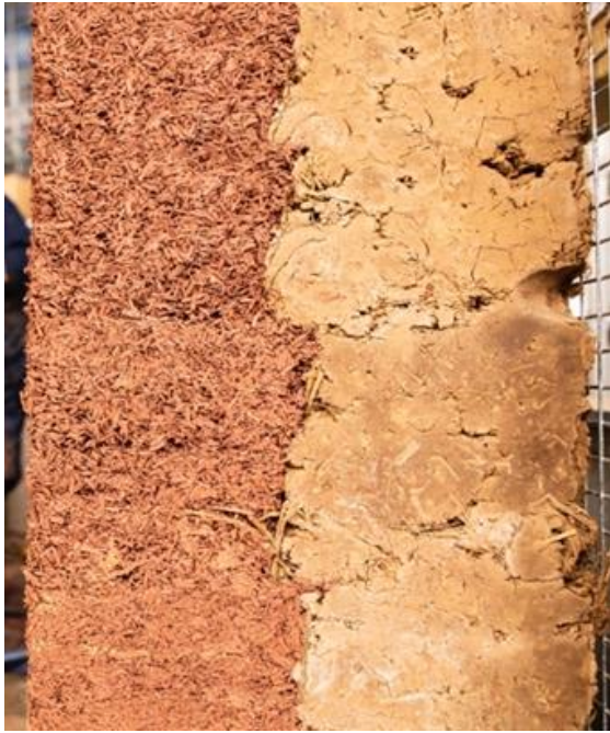
Figure 23 : Jointure en dents de scie angulaires entre couches structurales et thermiques. Photos : University of Plymouth, projet CobBauge
