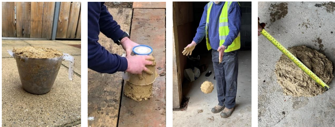
Figure 15 : Méthodologie d'essai d'impact de masse pour les mélanges de bauge structurelle. Photos : Katey Oven (2022).
